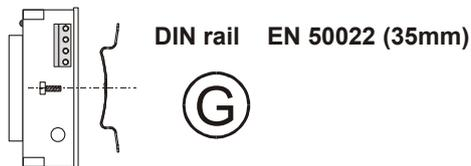
**!** G: Durch die mitgelieferte Feder kann das CoCo-PC auf Hutschiene montiert werden
